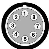
图 1: 电源接口针脚定义 (设备接口视角)
