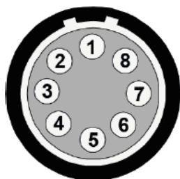
图 6: 10GbE上行接口针脚定义(设备接口视角)
