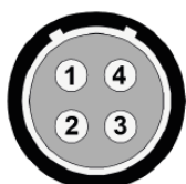
图 4: 同步接口针脚定义(设备接口视角)
