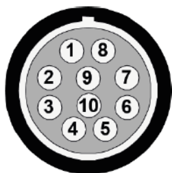
图 2: 系统连接接口针脚定义(设备接口视角)
