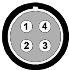
图 4: 触发接口针脚定义 (设备接口视角)
