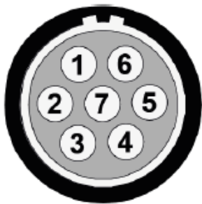
图 1: USB接口针脚定义 (设备接口视角) 接头型号: LEMO FGB.1B.307...
