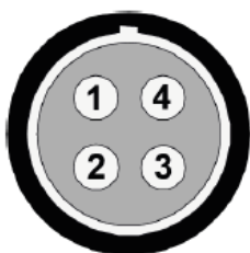
图 3: 电源接口针脚定义 (设备接口视角) 插头型号: LEMO FGG.2B.304...
