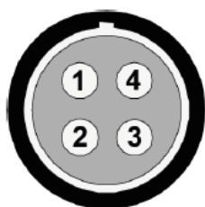
图 5: 触发总线针脚分配 (线缆接口视角) 插头型号: LEMO FGG.1B.304...
