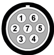
图 2: (MESSRING 产品编号4ADA621) 针脚分配, 2-8号插孔 (设备接口视角)
