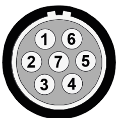
图 1: (MESSRING 产品编号4ADA621) 针脚分配, 1号插孔 (设备接口视角)
