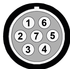
图 2: (MESSRING 产品编号 4ADA612) NA3x 针脚定义 (设备接口视角)
