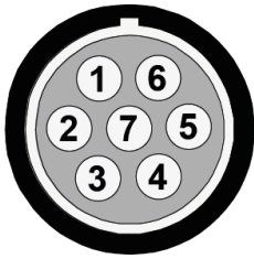
图3: (MESSRING 产品编号 4ADA618) CP 针脚定义 (设备接口视角) 插头型号: LEMO FGG.1B.307...
