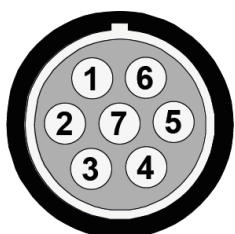
图 1: (MESSRING 产品编号 4ADA611) 标准针脚定义 (设备接口视角)
