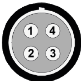
图 3: 电源针脚定义 (设备接口视角)
