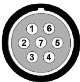
图 1: (MESSRING 产品编号4BBD211) 针脚标准分配 (设备接头视角) 插头型号: LEMO FGG.1B.307...
