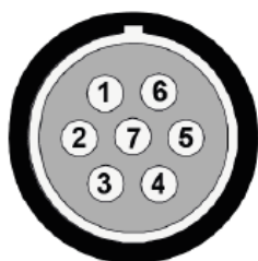
图 2: (MESSRING 产品编号 4BBD212) 针脚 NA3X 分配 (设备接头视角) 插头型号: LEMO FGC.1B.307...
