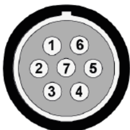
图 3: (MESSRING 产品编号 4BBD214) 针脚CP 分配 (设备接口视角) 插头型号: LEMO FGG.1B.307...
